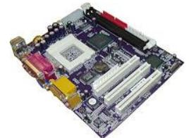
**Ranuras de Expansión:** Están ubicadas en la tarjeta madre y permiten conectar tarjetas de expansión que dotan al PC de ciertas capacidades. En esas ranuras se inserta, por ejemplo, la tarjeta de sonido (que permite al PC reproducir sonido) el módem interno (que hace posible navegar por internet) la tarjeta de vídeo (que permite mostrar imágenes en la pantalla). Una tarjeta madre moderna deberá incluir tres tipos de ranuras de expansión: ISA, PCI y AGP.
