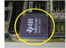
10.- Chipset: Conjunto de Chips que se encargan de controlar determinadas funciones del ordenador, como la forma en que interacciona el microprocesador con la memoria o la caché, o el control de los puertos y slots
